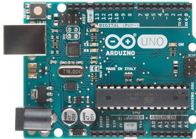
Imagen 3 - Ubicación de los pines PWM en Arduino UNO (3, 5, 6, 9, 10, 11)
